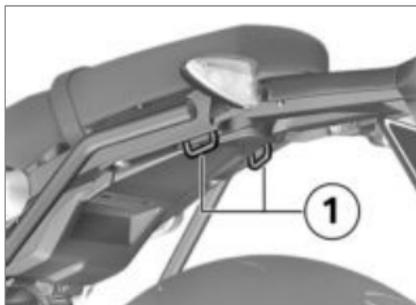
Fixer le bagage (par exemple sac arrière) sur les anneaux d'arrimage **1**.
